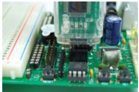
ภาพการต่อกับ ISP-Programmer (3 PIN)
