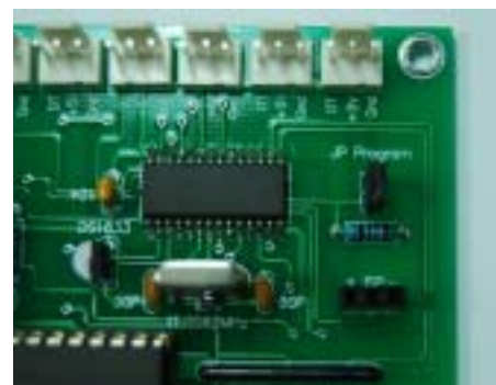
ภาพบริเวณ Jumper และขั้ว ISP บนบอร์ด
